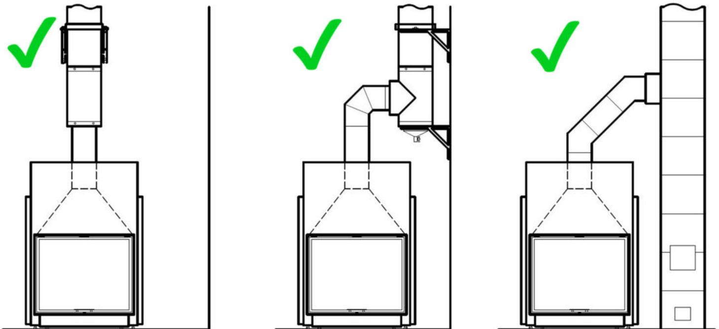
Рисунок 6. Допустимые варианты сопряжения со стальным и минеральным дымоходом.
