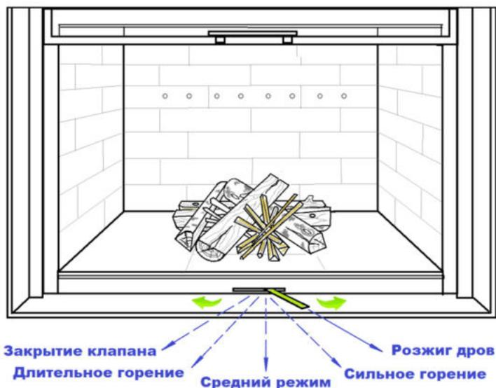
Рисунок 13. Положения регулятора подачи воздуха на горение.
