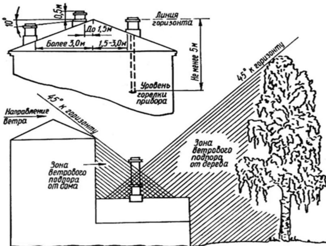
Рисунок 9. Схема расчета высоты дымохода над кровлей.
