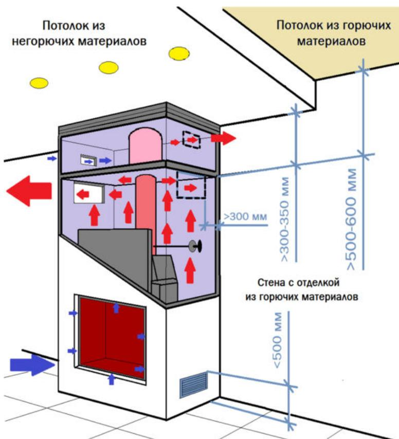
Во всех конвекционных коробах, в особенности, если они примыкают к потолку, устанавливается так называемая отсечка (фальшпотолок, отсечной потолок). Это горизонтальная или незначительно наклоненная сплошная перегородка из негорючего материала, расположенная в верхней половине короба.
