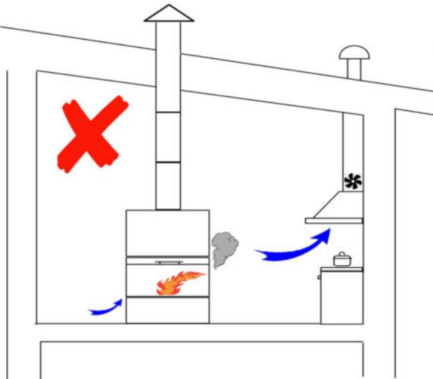
Рисунок 1. Отсутствие притока воздуха в помещении с вытяжкой.
