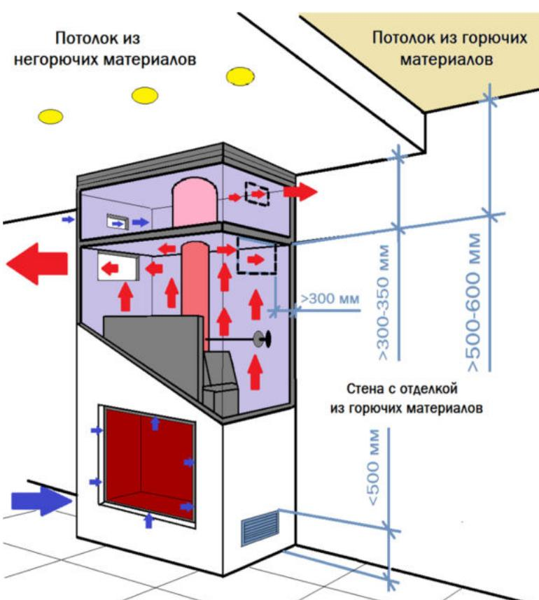
Рисунок 11. Размеры для установки отсечки и проемов (решеток).
