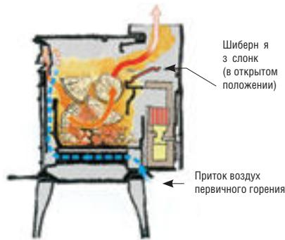
При открытом положении шибера заслонки дым быстро поднимается вверх и направляется непосредственно в трубу.
