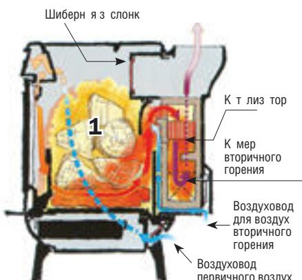
В глубине камеры первичного горения устроена еще одна топка — камера вторичного горения. Когда шиберная заслонка находится в закрытом положении, газы проходят через катализатор и при низкой температуре в 230°C все примеси в них эффективно сгорают.
