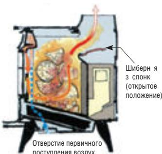
При открытом шибере отработанный воздух вместе с дымом вертикально поступает в дымоход.
