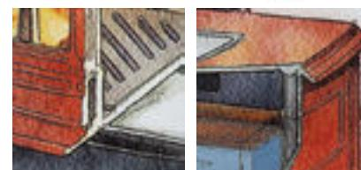
Слева: для увеличения герметичности при закрытой створке дверцы, согласно точному расчету, вторая створка плотно входит в паз с помощью фиберглассового шинника
