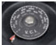
■ Термометр-щуп напрямую измеряет температуру катализатора.
