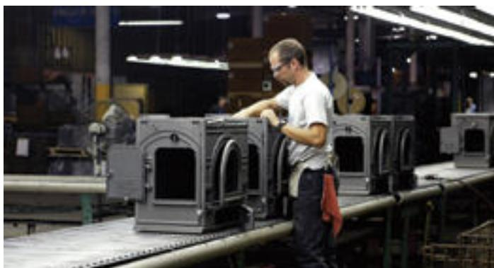
■ Ручная сборка печей на заводе «Vermont Castings».
