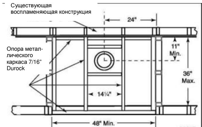
**Рисунок 19 Отраженный план потолка**
