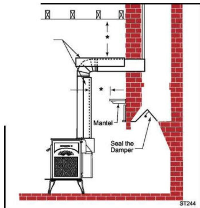
**Рисунок 7 Соединительный элемент входит в дымоход над камином**
