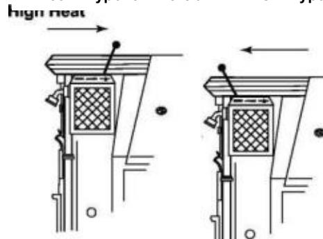
Рисунок 33. Ручка терморегулятора может находиться в любом положении в зависимости от требуемого уровня излучаемого тепла.
