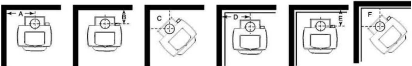
\* Для того, чтобы расположить центр воротника трубы добавьте 7" (180 мм) к расстоянию от угла печки до стены. Отмерьте получившееся расстояние от угла вдоль стен. Затем отмерьте то же расстояние от этих двух точек в направлении от стены. 2 получившиеся отметки пересекутся в точке и покажут центр воротника трубы. Смотри диаграмму, представленную выше.
