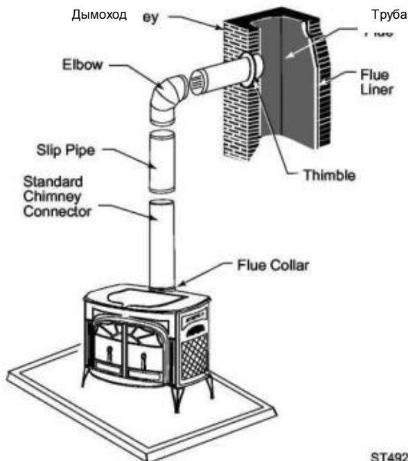
**Рисунок 6 Подсоединение дымохода при свободностоящей версии**
