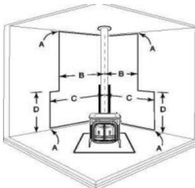
**Рисунок 23.** Угловая установка, вертикальный соединительный элемент дымохода, печка, соединит.элемент и изоляция стены. Изоляции стены ДОЛЖНЫ соединиться в углу. Изоляция для элемента соединения тянется 28" (710 мм) над воротником трубы. Изоляция потолка, диаметр которой составляет 24" (610 мм), должна проходить вокруг дымохода и отходить от потолка на 1" (25 мм).
