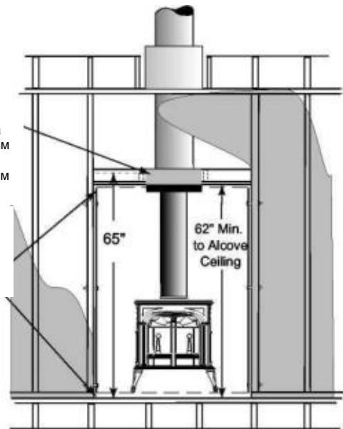
**Рисунок 20 Вид спереди:** минимальное расстояние 1651мм (65") от очага до легковоспламеняющихся материалов на фронтальной стороне. Воспламеняющаяся облицовка может соединяться внахлестку с металлическим каркасом только на 2,54 см (1"). Она не должна быть больше не воспламеняющегося потолка по высоте
