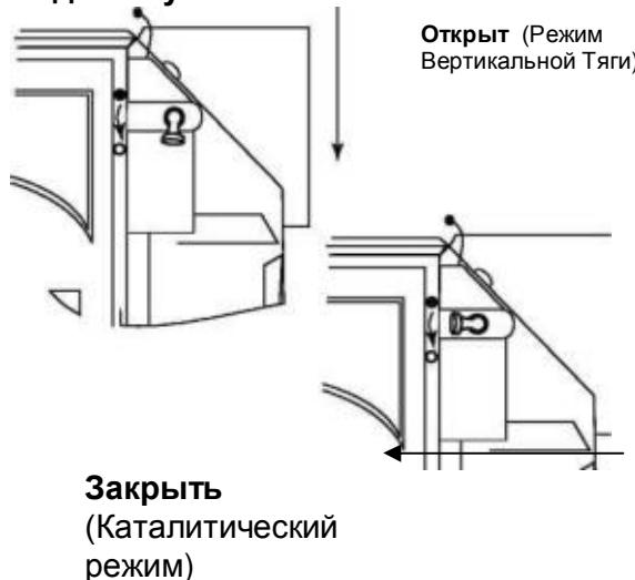
Рисунок 34. Заслонка открыта или закрыта, промежуточного положения нет.
