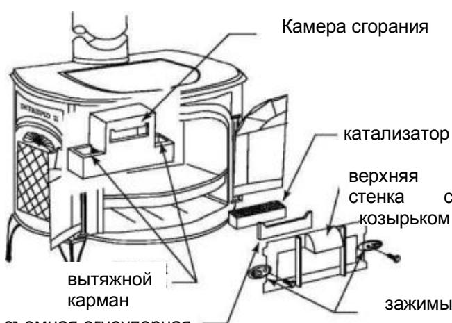
**Рисунок 46. Снятие элемента каталитического сгорания**
