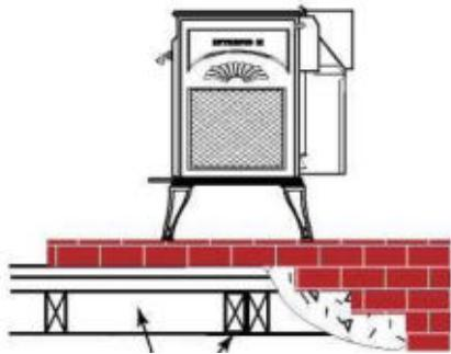
Деревянная конструкция требует защиты от излучаемого тепла
