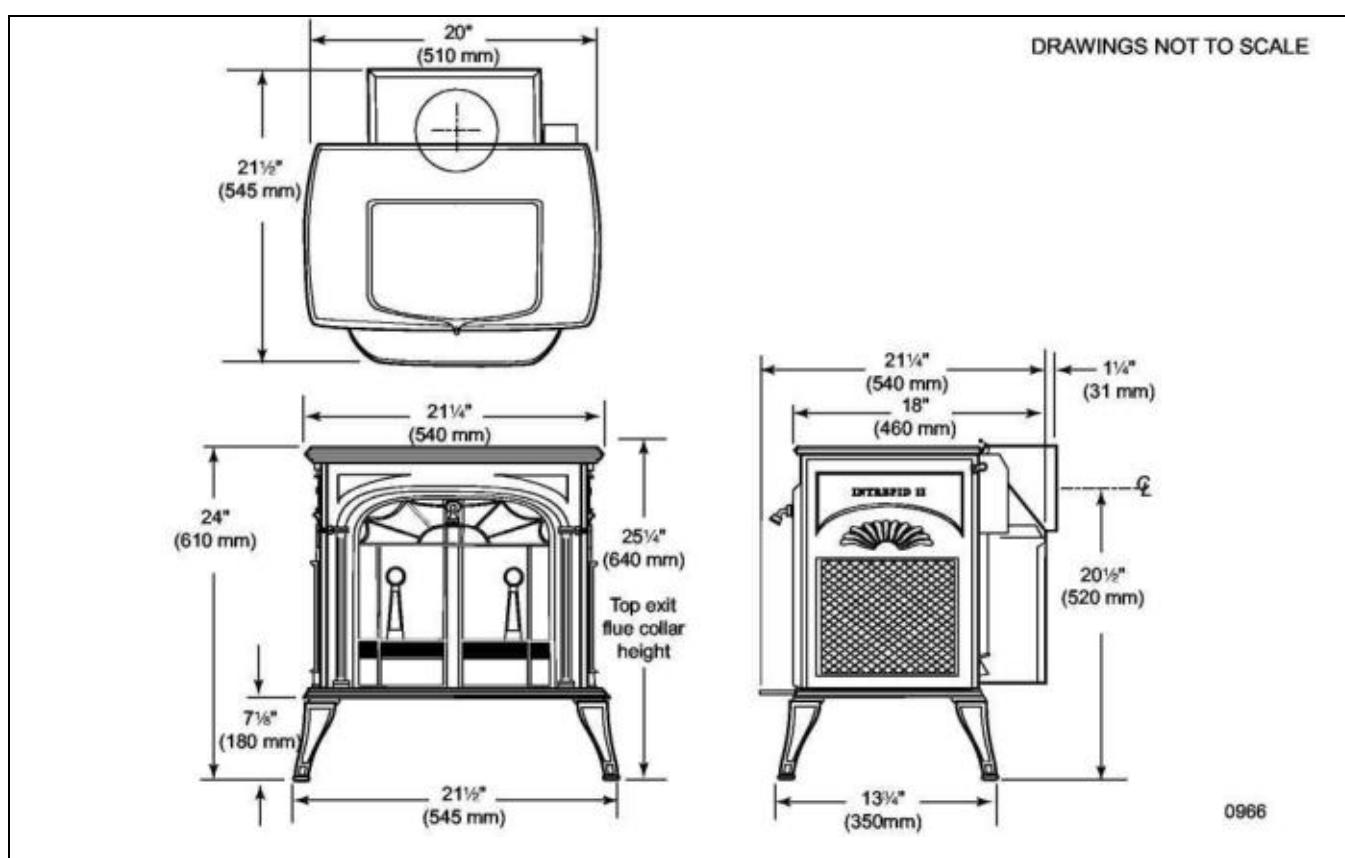
Рисунок 1. Размеры модели Intrepid II, 1990
