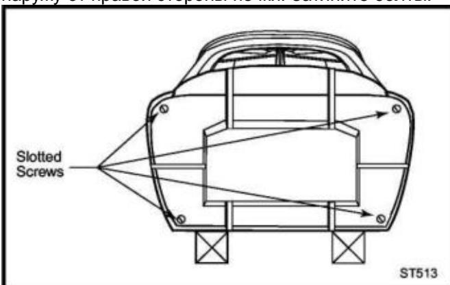
**Рисунок 27. Выкрутите болты из нижней части печки.**
