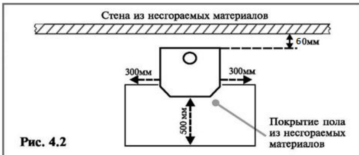
Стену или перегородку из горючих материалов, примыкающую под углом к фронту печи, защищают штукатуркой толщиной 25 мм по металлической сетке, или негорючим теплоизоляционным листовым (плитным) материалом по негорючему утеплителю толщиной 10 мм, на высоту - от пола и до уровня, на 250 мм выше верха топочной дверки.
