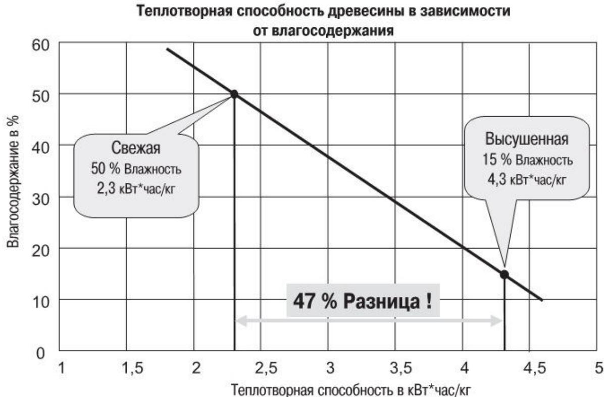
Сжигание древесины с высокой влажностью чрезмерно перегружает топку и сокращает срок её службы. При повторном сжигании влажного дерева, топка или части топки могут быть повреждены и это будет способствовать загрязнению трубы и увеличению риска возникновения сажи в дымоходе, что может привести к возникновению пожара.
