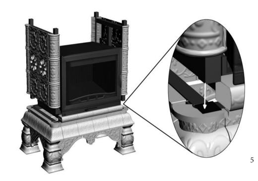
Шаг 4. Установка задней стенки в направляющие как показано на рисунке.
