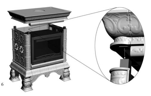
Шаг 6. Установка стенок второго яруса аналогично нижним стенкам.
