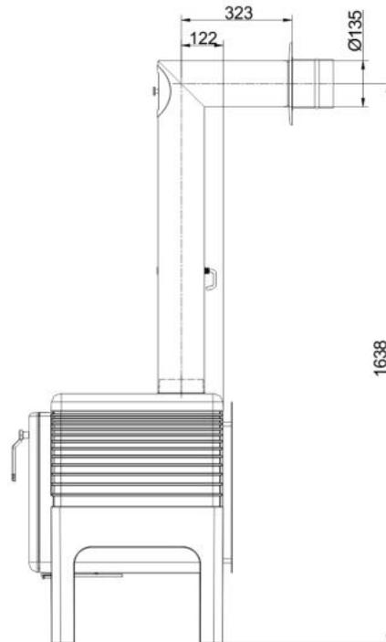
... mit Abgasrohr-Anschlussset horizontal und L
