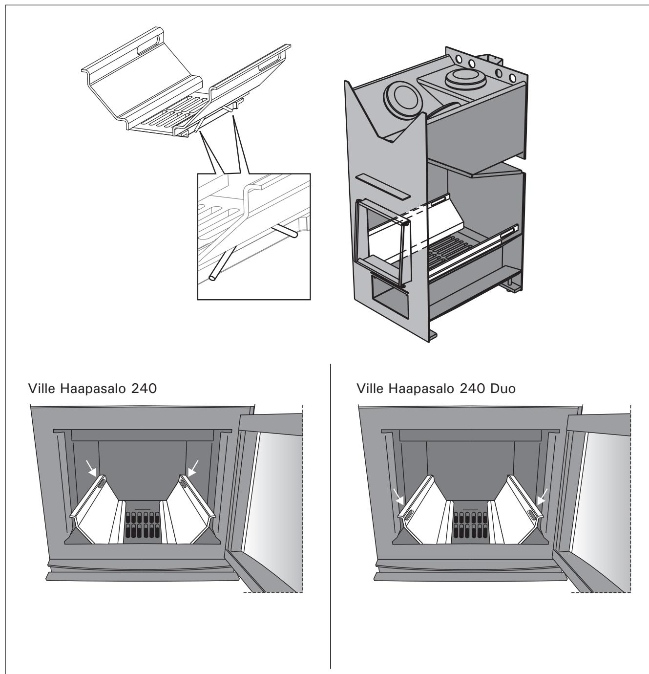
Рисунок 2. Каналы для подачи воздуха для горения
