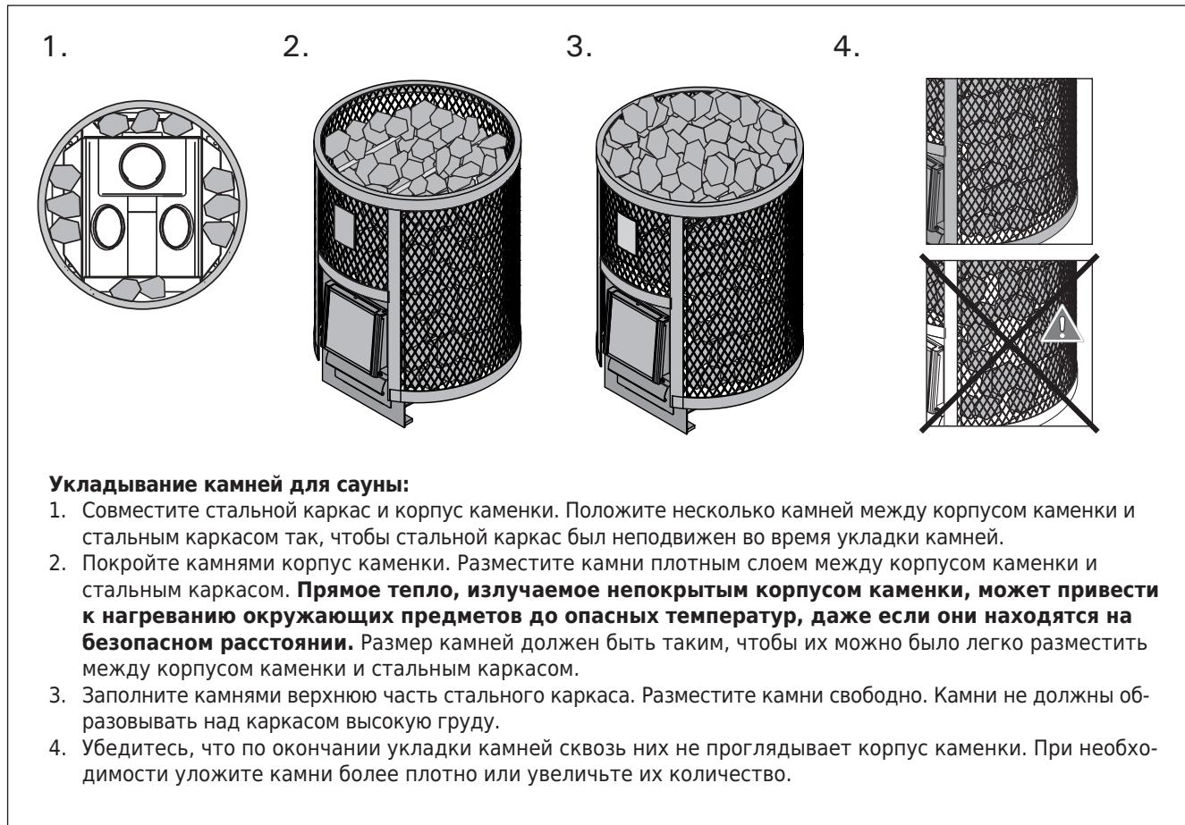
**Рисунок 3. Укладка камней**
