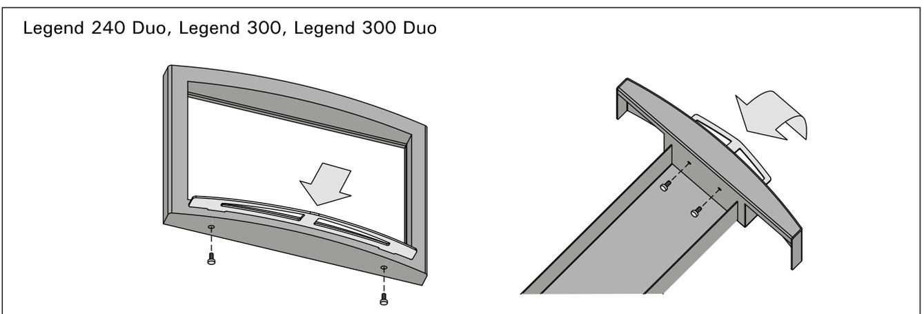
Рисунок 16. Установка ручкояток
