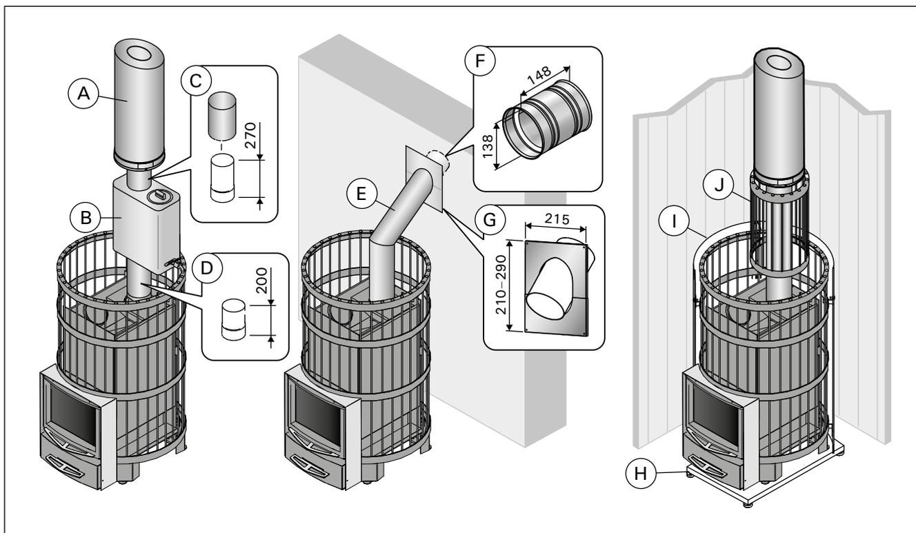
Рисунок 17. Дополнительные принадлежности (все размеры приведены в миллиметрах)
