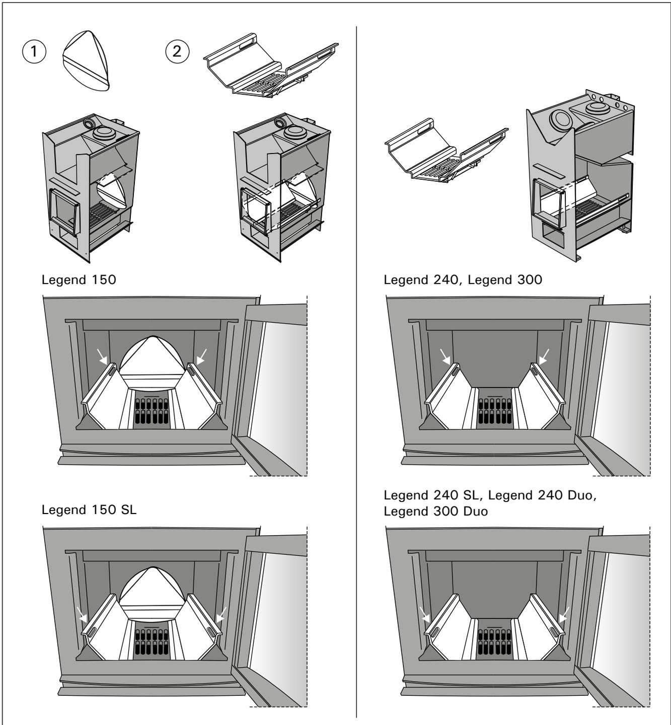
**Рисунок 2. Каналы для подачи воздуха для горения**
