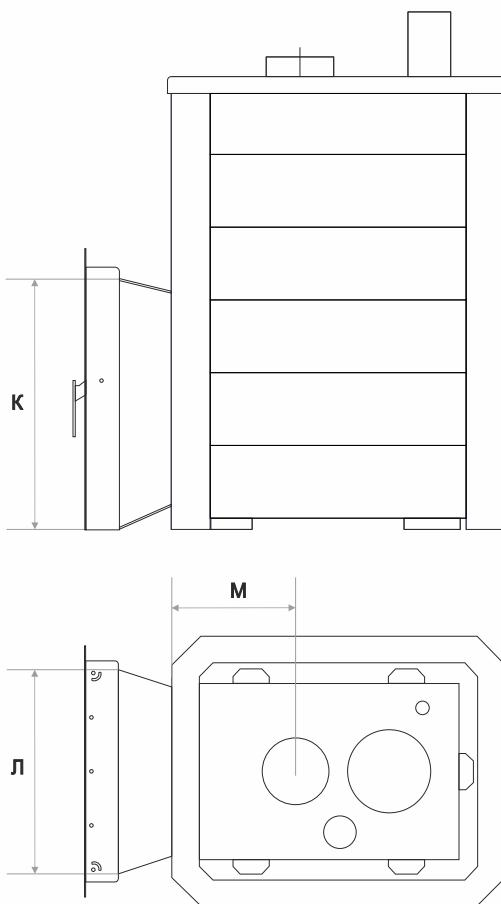
Рис. 5 Габаритные размеры печи
