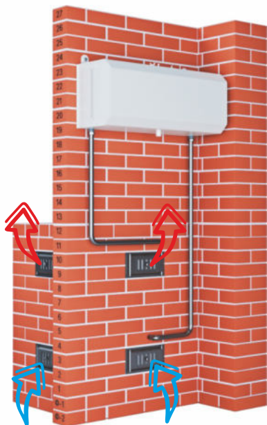
Рис. 5 Пример установки печи в кирпичном кожухе с функцией обогрева комнаты отдыха и моечного отделения
