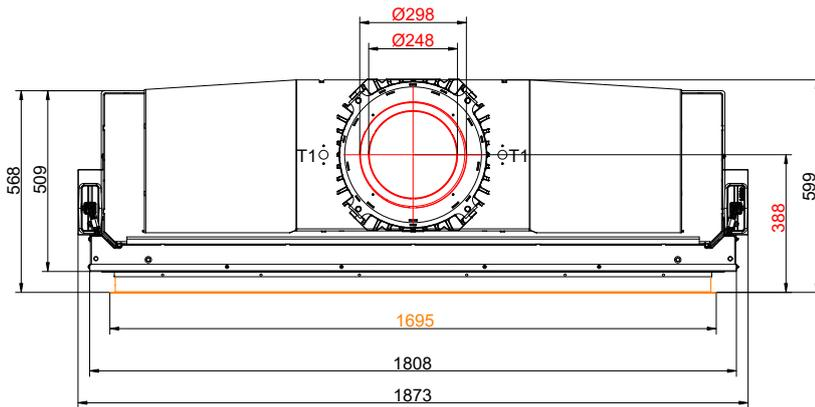
... mit Blendrahmen und 4x Wärmetauscherringe Guss
