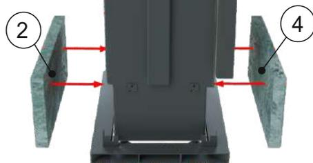
Принцип крепления уголка к деталям из камня болтами М5х20
