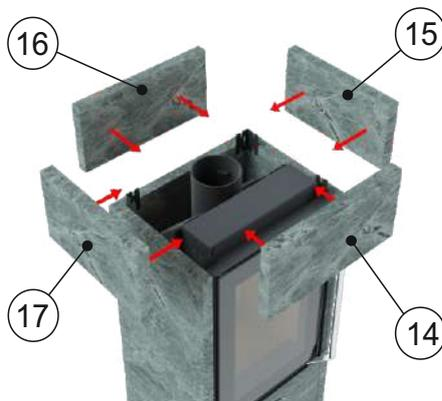
16 Установите верхнюю рамку, совмещая прорези на рамке с крепёжными отверстиями на камне, закрепите болтами М5х20 - 8 шт.
