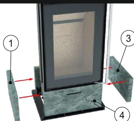
5 Установите уголки «3У» - 2 шт по углам в передней части и уголки «2У» - 2 шт в задней части, закрепив болтами М5х20 - 8 шт.
