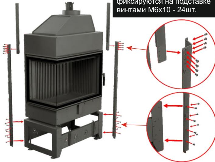
Соедините между собой верхнюю и нижнюю часть стойки винтами М6х10 - 24шт. Направляющие фиксируются на подставке винтами М6х10 - 24шт.
