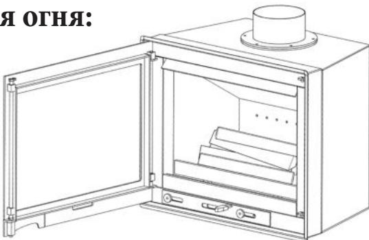
**Важно**, чтобы дрова разгорались быстро. Для этого нужно установить регулятор подачи воздуха в максимально открытое положение (рычаг вправо до упора), и оставить дверцу топки приоткрытой на время разгорания дров.
