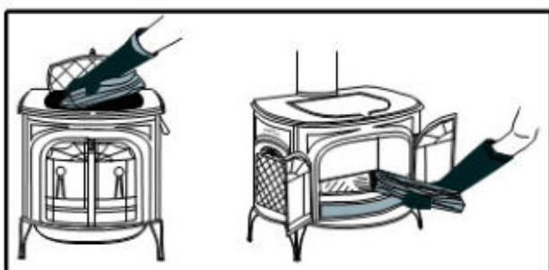
Рис. 25 Верхняя загрузка топлива считается приоритетной для добавления дров. Фронтальная загрузка используется для разжигания. Однако фронтальные дверцы открываются также
