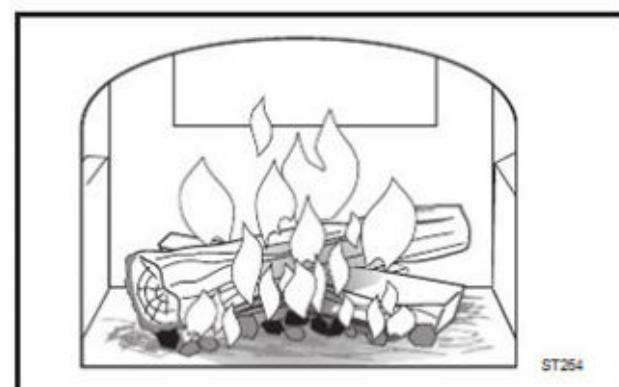
Рис. 29 Большие дрова добавьте, когда огонь хорошо разгорится
