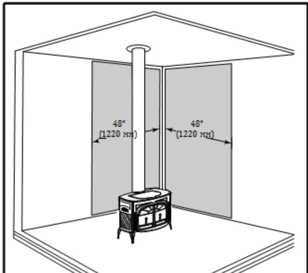
Рис. 9 Параллельная установка
