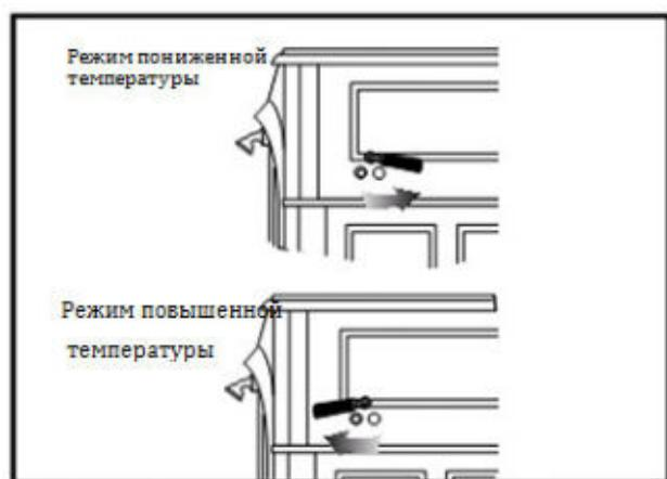
Рис. 23 Ручку также можно устанавливать на промежуточный уровень между двумя режимами
