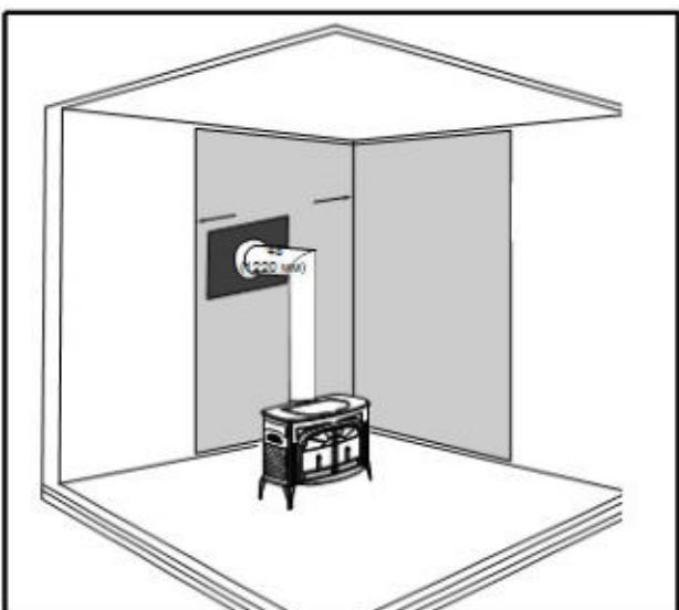
Рис. 10 Параллельная установка с проходом через заднюю стену
