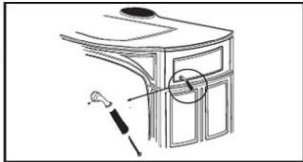
Рис. 16 Установка ручки терморегулятора
