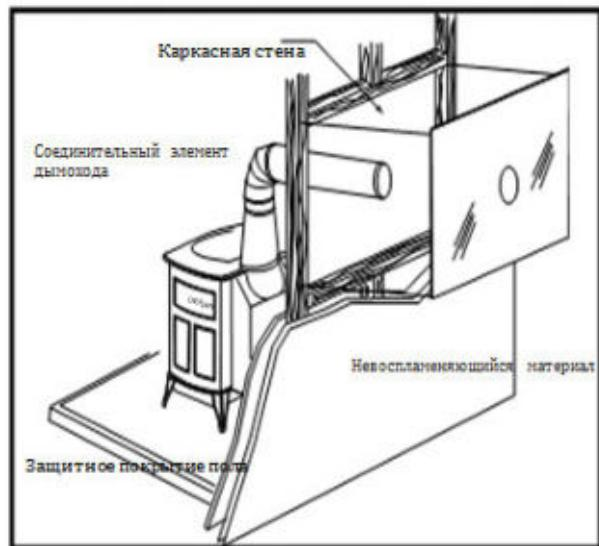
Рис. 4 Установка через стену
