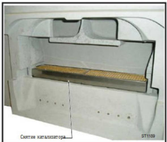
Рис. 21 Снятие катализатора
