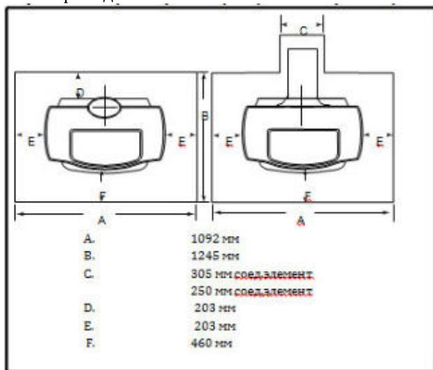
Рис. 5 Размеры напольного покрытия
