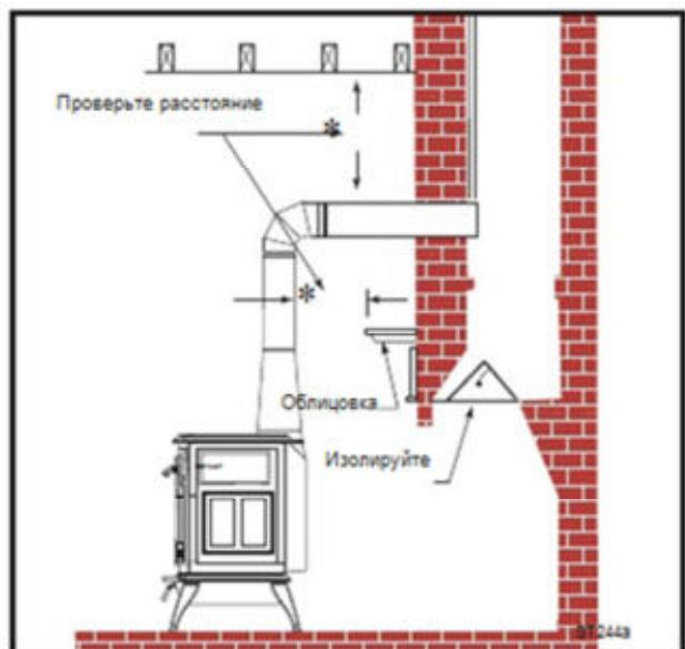
Рис. 2 При таком методе установки соединительный элемент соединен с дымоходом над проемом дымохода.
