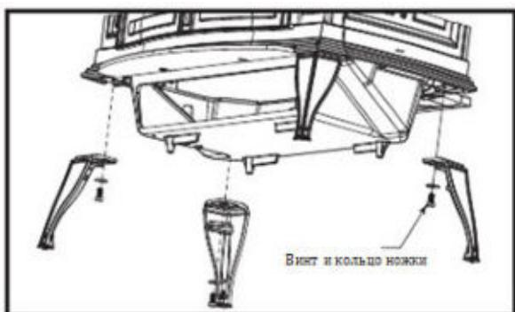
Рис. 13 Закрепление ножек
