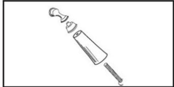
Рис. 17 Сборка ручки дверцы
