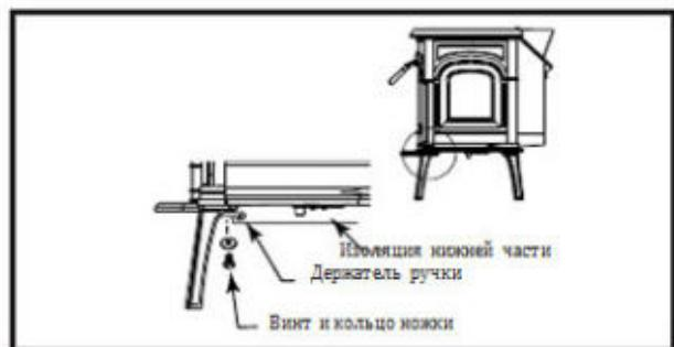
Рис. 14 Расположение изоляции и держателя ручки
