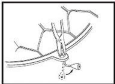
Рис. 12 Установка ручки
