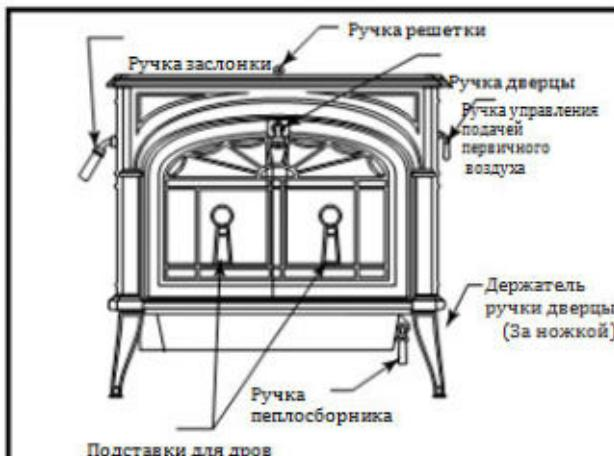
Рис. 22 Ручки управления печи Encore расположены удобно и ими легко управлять.
