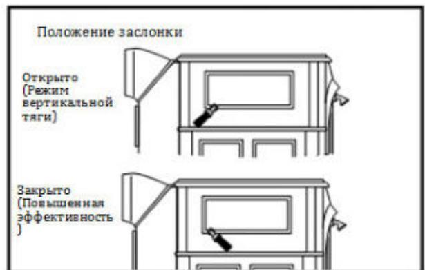
Рис. 24 Положения заслонки печи Encore
