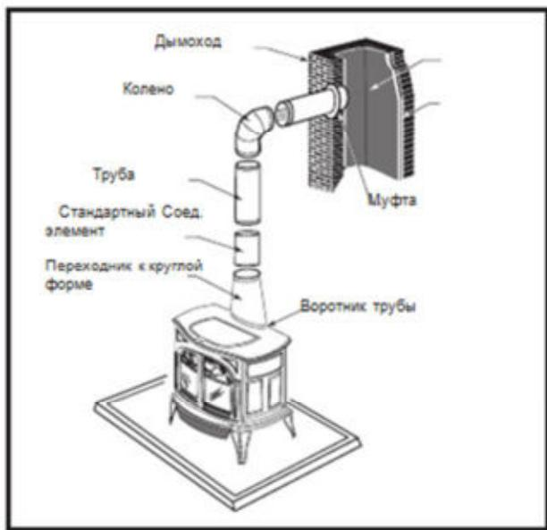
Рис. 1 Изображение соединительного элемента дымохода при свободностоящей версии установки
