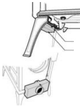
Фигура 23. Прикрепление выходной части пеплосборника к нижней части печи
